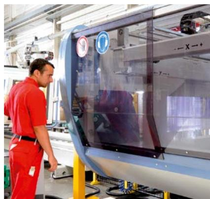
Copertura di macchine in SIMOLUX
