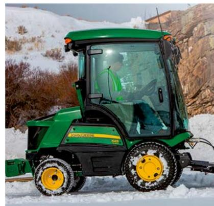
Copertura del motore di un trattore John Deere in PMC® StrataGem™
