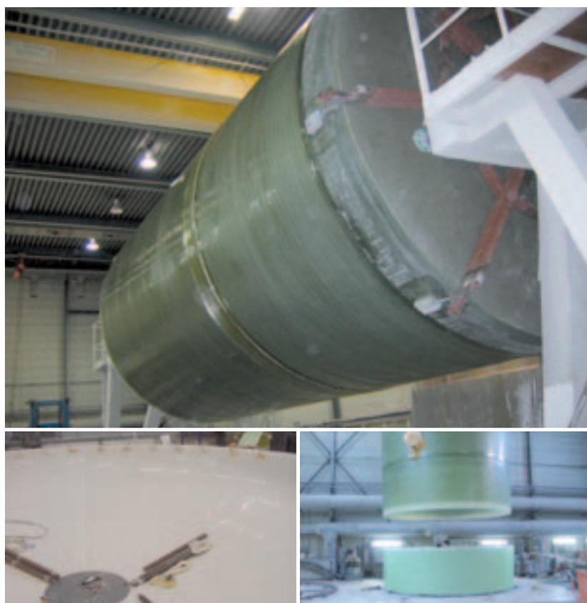
Les cuves composites en plastique renforcé à la fibre de verre présentent une hauteur de onze mètres et un diamètre de cinq mètres.
