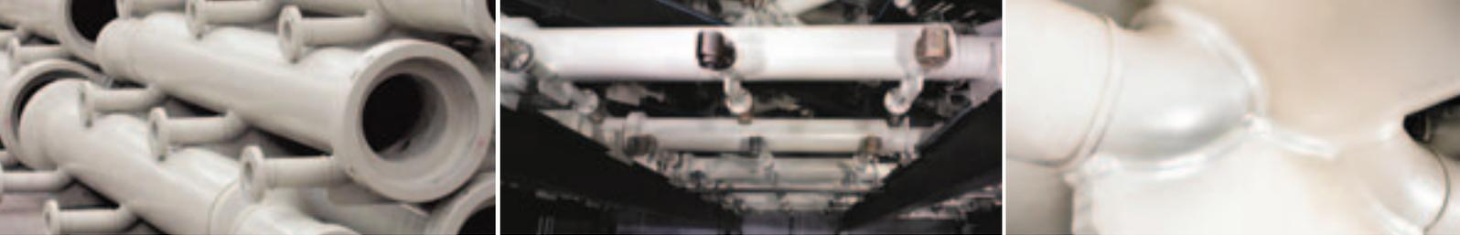
Abb. v.l. n. r.: Vorgefertigte Düsenlanzenteile; Montierte Düsenebene; Extrusionsschweißnähte der Abgänge für die Düsen
